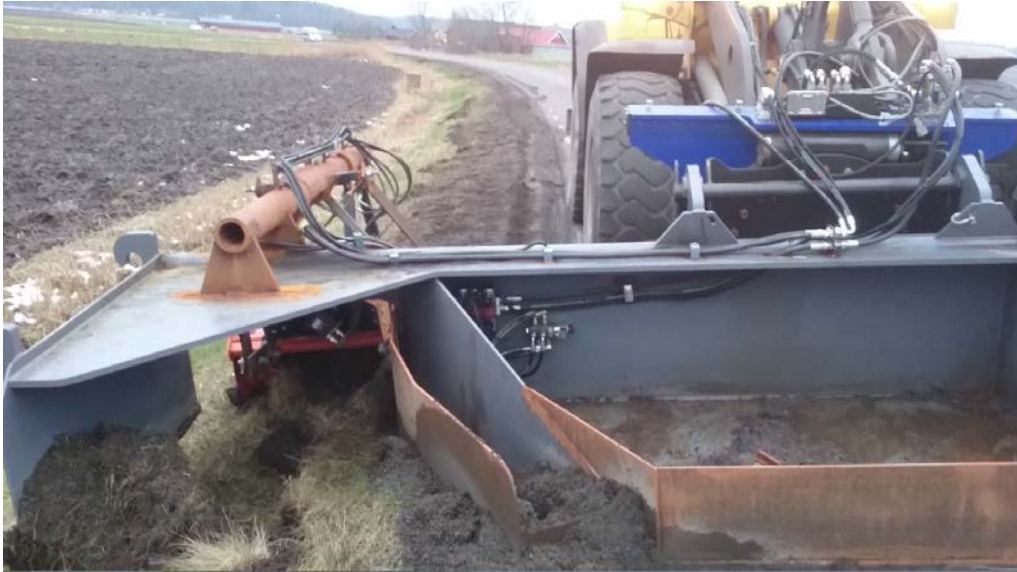
Bild 4, Vinkeln på plåt, snäv än nedan, regleras inifrån hytten utifrån materialmängd
