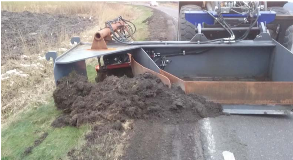
Bild 5, Transportfästen på sidan av skopan underlättar transport ut till arbetsplats
